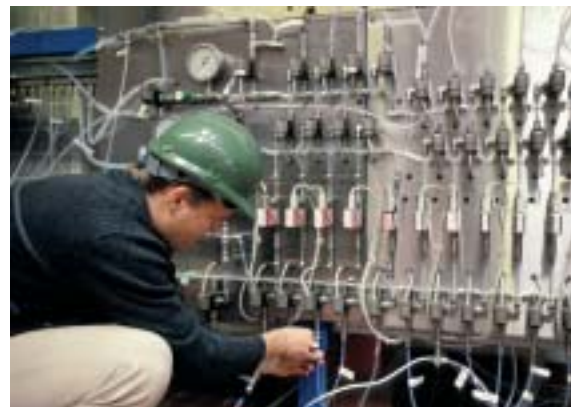
Forskningsassistent Jesper Jensen arbejder med flowforsyningspanelet.
