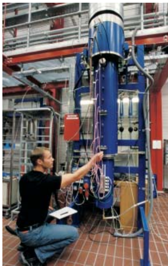
Ph.D.-studerende Jacob Nygaard Knudsen arbejder på fixed bed reaktor.
