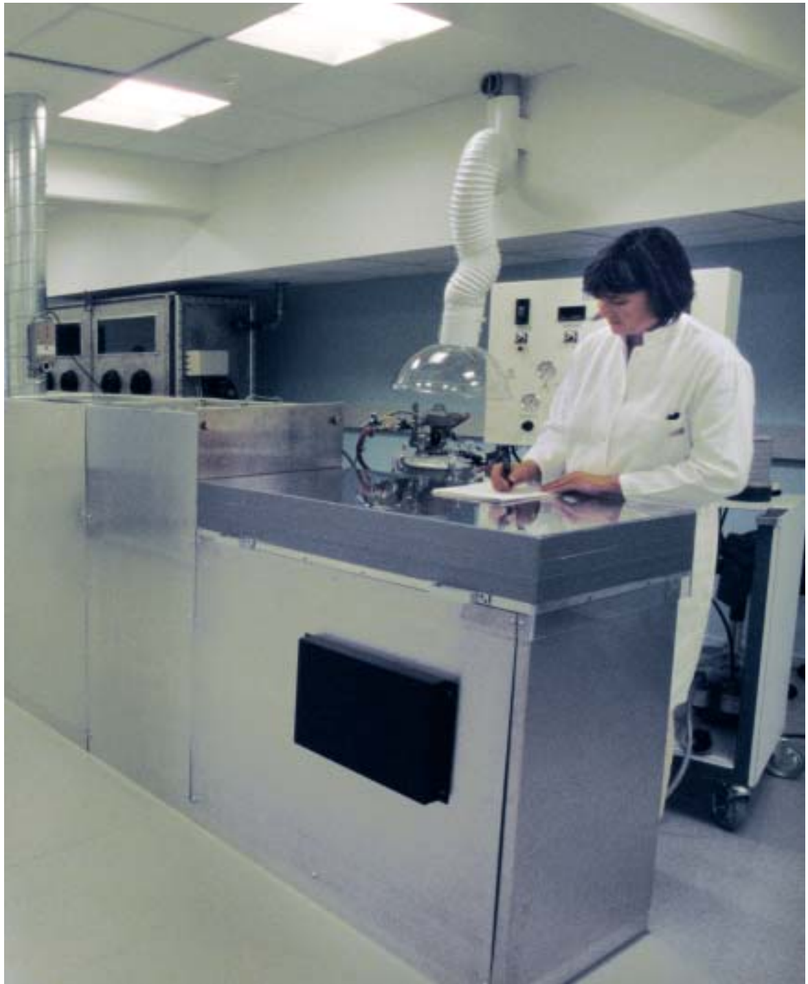
Der arbejdes med tape casting af anodesupport til SOFC-celler.
