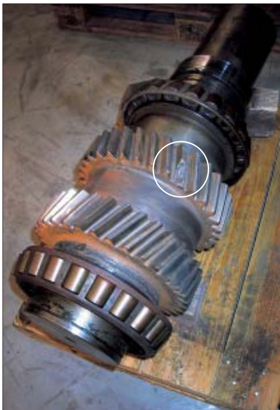
Billedet viser et beskadiget tandhjul fra Tjæreborgmøllen.
