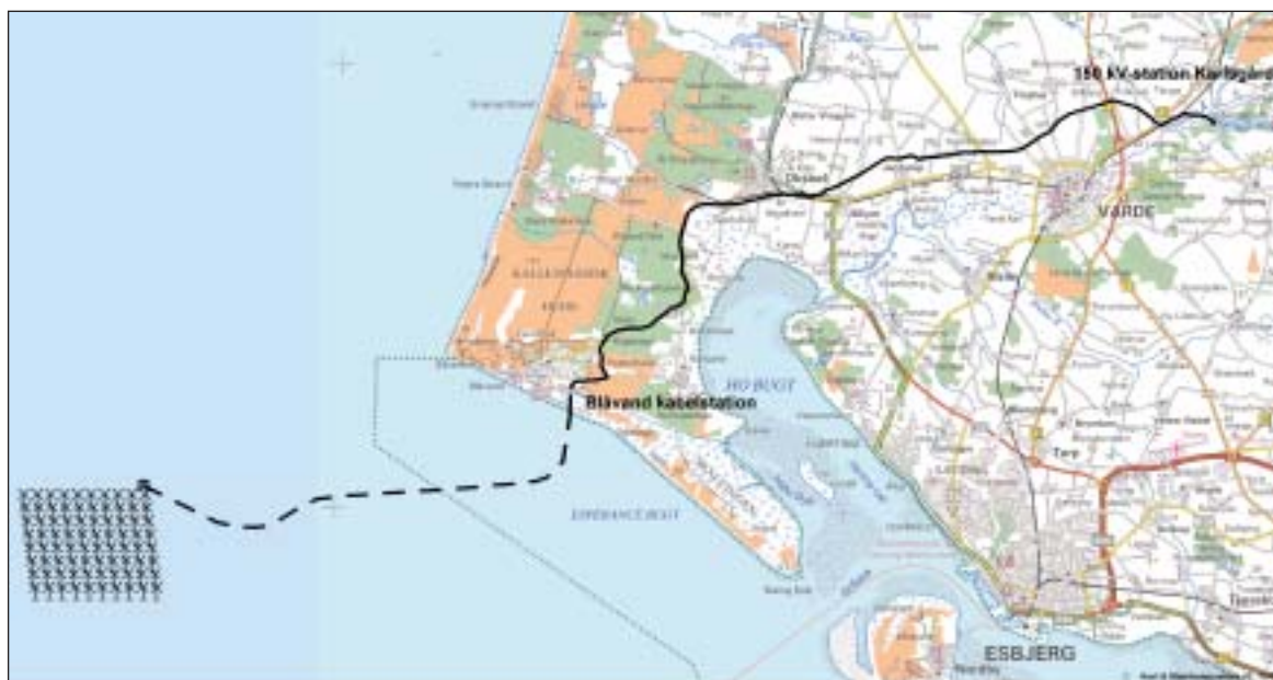
Figur 5 Linjeføringen for ilandføringskablet fra vindmølleparken ved Horns Rev.
