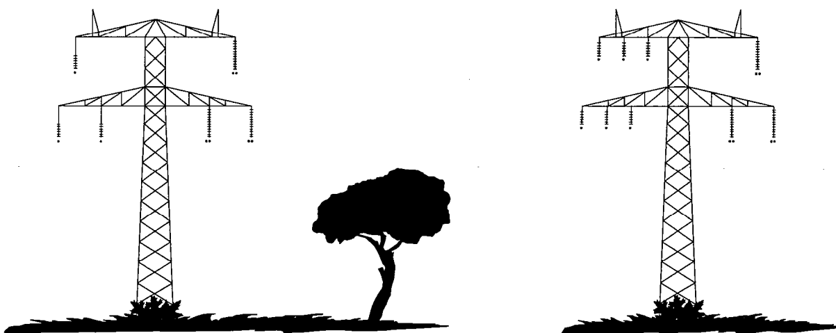
Figur 1: På en 400 kV-tosystemsmast kan der enten hænges to 400 kV-systemer op eller, som vist, 400 kV på den ene side og et eller to 150 kV-systemer på den anden side.
