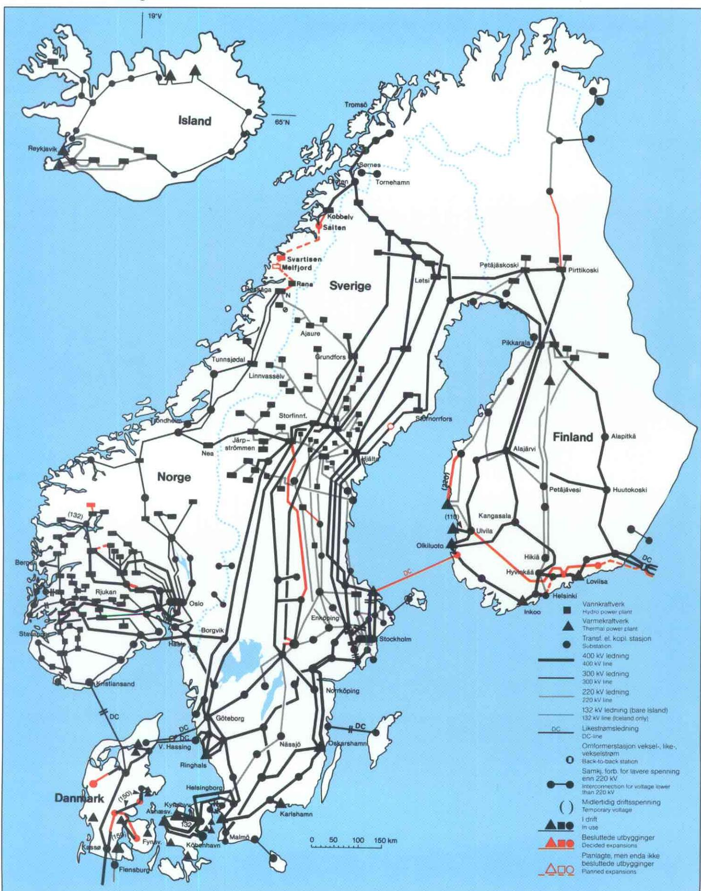
**Fig. S6 Samkjøringsforbindelser mellom Nordelandene**
