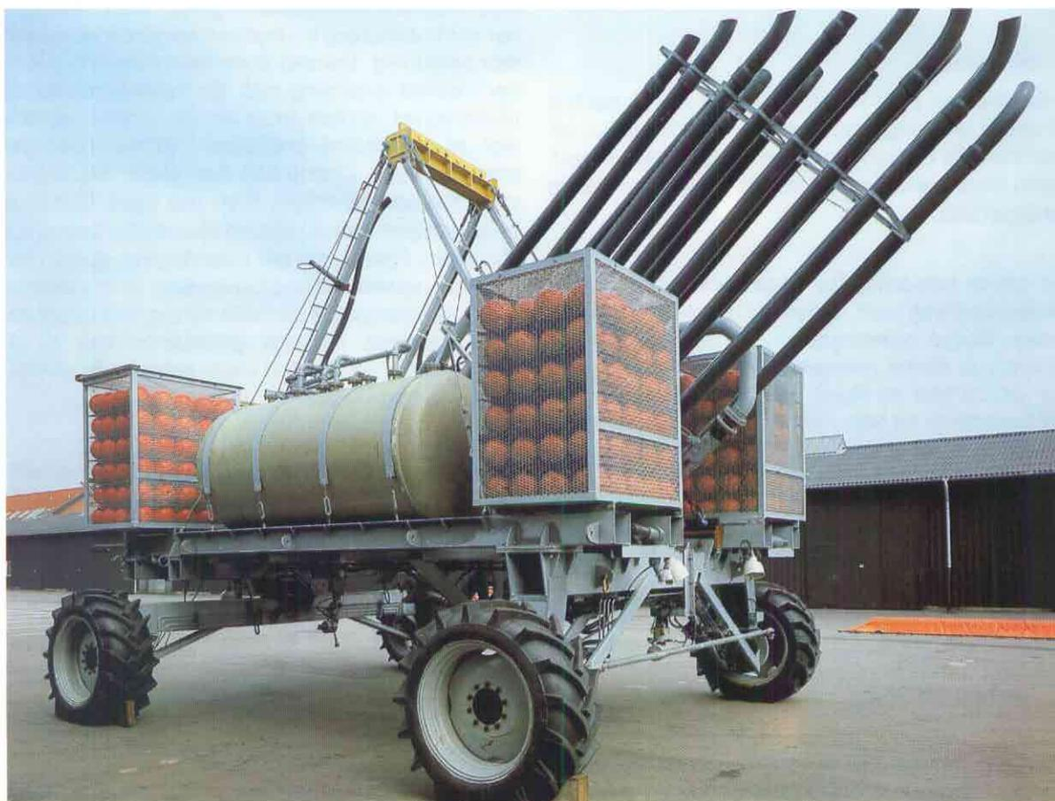
»Sofus«, som benyttes til nedspuling af Skagerrak-kablerne på vanddybder op til 100 m.
