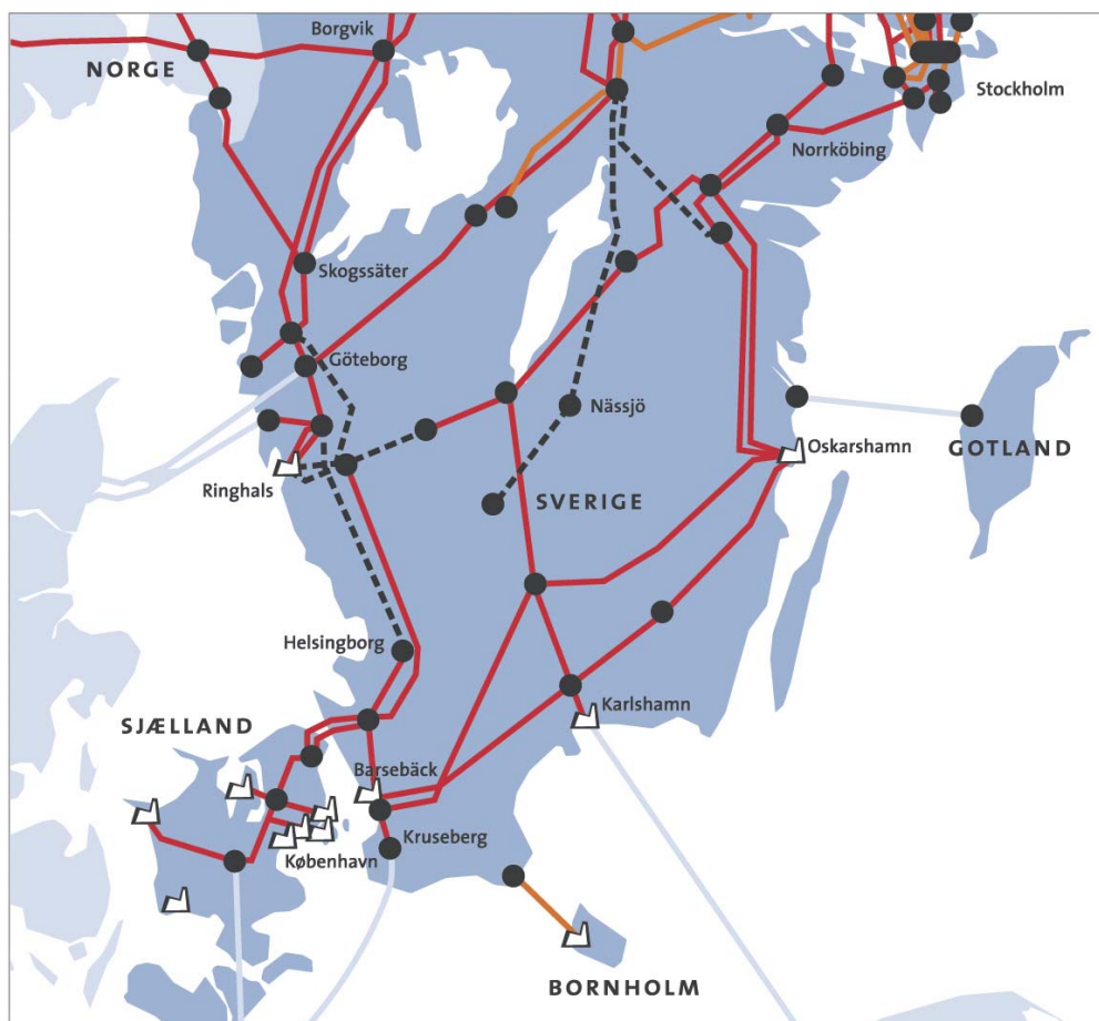
Figur 2. Nettets koblingstilstand ca. 10 sekunder efter kortslutningen i Horred. De udkoblede transmissionsledninger i det svenske stamnet er vist stiplet. Det ses, at kun to 400 kV ledninger på østkysten forbinder Sydsverige med Mellemsverige. Spændingsfaldet hen over disse ledninger bliver meget stort på grund af ledningernes længde kombineret med de store strømme i ledningerne.
